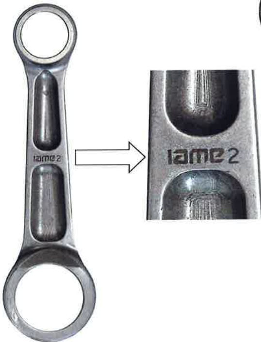
PHOTO IDENTIFICATION CONROD MARQUAGE D'IDENTIFICATION DE LA BIELLE
