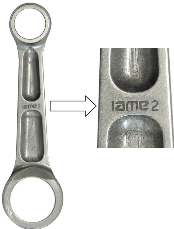
PHOTO IDENTIFICATION CONROD MARQUAGE D'IDENTIFICATION DE LA BIELLE
