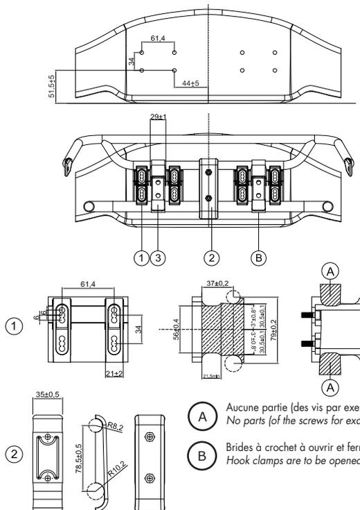
Il n'est permis de fixer le carénage avant sur le kart qu'au moyen du kit de montage de carénage avant. Aucun autre dispositif n'est autorisé. Le carénage avant doit pouvoir reculer librement en direction du châssis sans aucune obstruction d'une partie quelconque pouvant limiter le mouvement.
